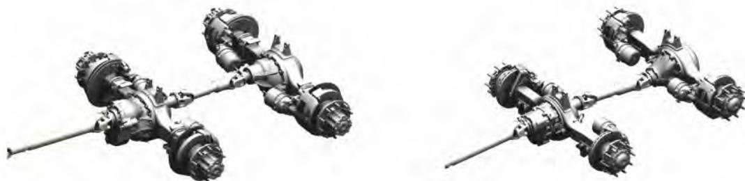
На автомобилях KAMAZ-65206 устанавливается тандем ведущих мостов Daimler HD4/HL4 или Dana DD150/R150 (в зависимости от комплектации) с гипоидной главной передачей. Грузоподъемность тандема до 19 т.
