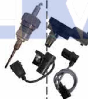
Датчики давления и температуры, фазы, синхронизации
